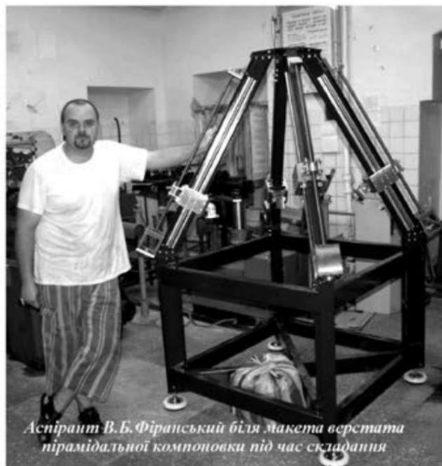
Аспірант В.Б.Фіранський біля макета верстата пірамідальної компоновки під час складання
