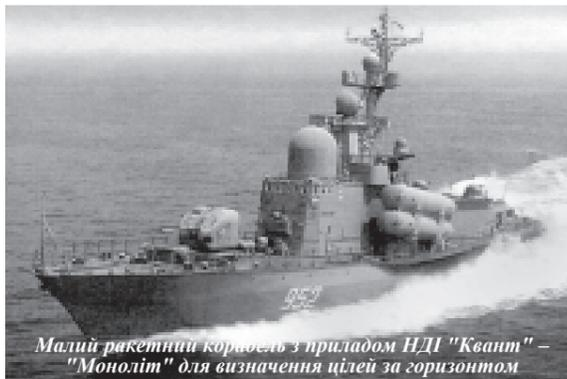
Малий ракетний корабель з приладом НДІ "Квант" – "Моноліт" для визначення цілей за горизонтом
