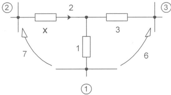
На рисунке приведен фрагмент некоторой схемы. Через сопротивление  $x$  протекает ток 2 А, напряжение между узлами 2, 1 и 3, 1 равно соответственно 7 В и 6 В. Определить величину сопротивления  $x$ .
