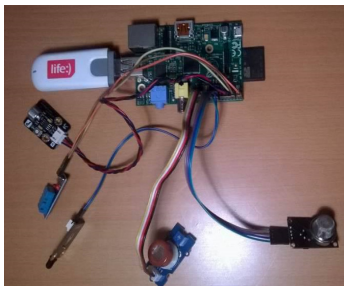
Макет вузла БСМ для дистанційного моніторингу температури та вологості за допомогою сенсорного датчика
