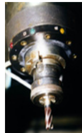
Активний відчутник торкання інструмента та блок «МАЙСТЕР-10»
