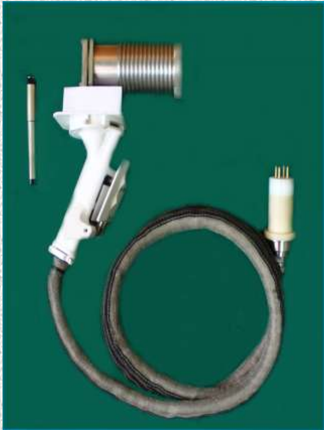
Ручна електронно-променева гармата з високовольтним роз'ємом Hand electron beam gun with high-voltage connector
