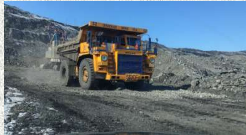
Самоскид вантажопідйомністю 110 т. Dump-truck of 110-ton capacity
