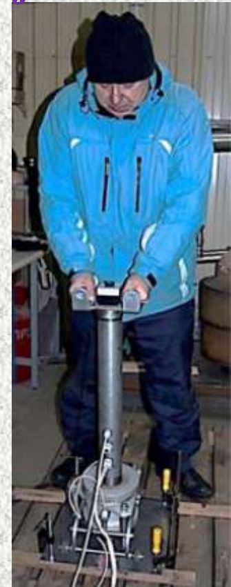
Правлення методом ЕДО зварної листової конструкції сплаву АМгб товщиною 8 мм
