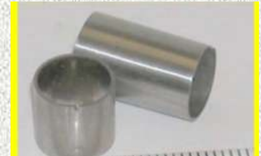
Оболонки термоемісійних перетворювачів Shells of thermoemission converter
