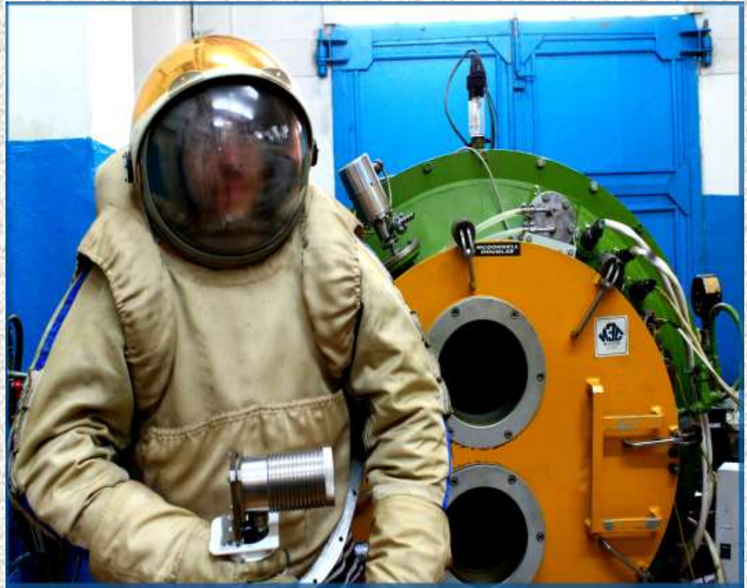
Зварювальник – дослідник з новим електронно-променевим інструментом Welder-tester with new electron beam tool
