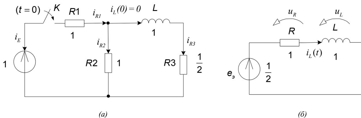
Рис. 12.6. (а) схема для расчета переходной характеристики как реакции на замыкание ключа; (б) упрощенная схема, эквивалентная исходной.
