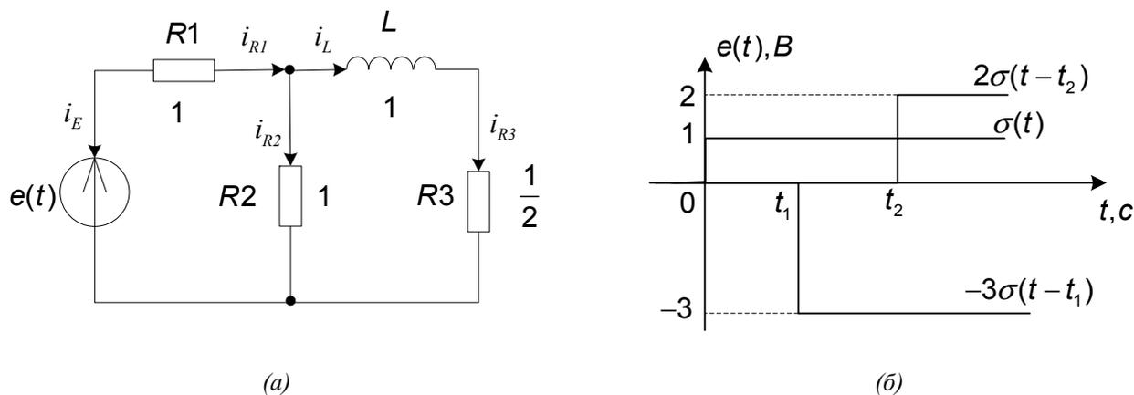
Рис. 12.5. (а) исходная схема с указанными полюсными токами; (б) сигнал  $e(t)$ , представленный как сумма ступенчатых функций Хевисайда.
