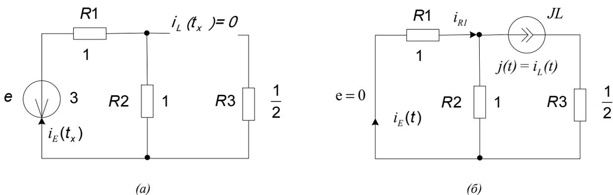
Рис. 12.7. (а) исходная схема в момент времени  $t_x$ , когда ток через индуктивность равен нулю; (б) исходная схема на интервале  $[t_2, \infty)$ .
