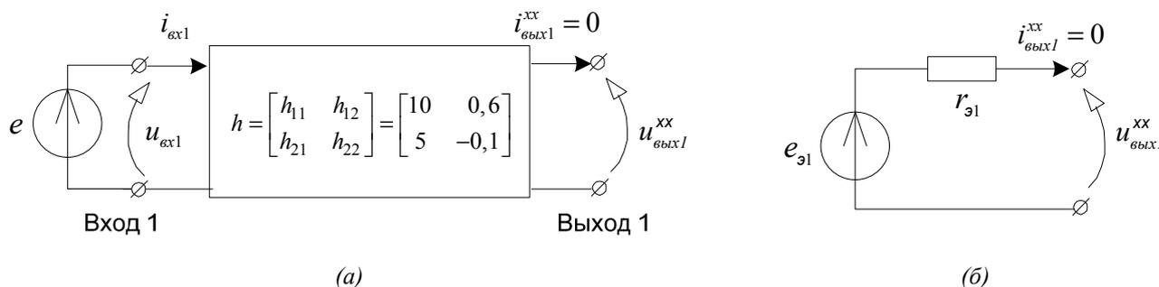
Рис. 12.1. (а) система 1 в режиме холостого хода на выходе; (б) эквивалентная схема Тевенена.
