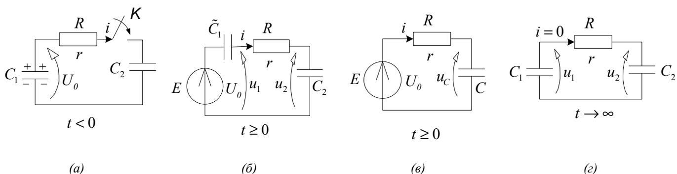
Рис. 12.4. (а) схема до замыкания ключа (начальное состояние); (б) схема во время переходного процесса (переходное состояние); (в) упрощенная схема (б); (г) схема после завершения переходного процесса (установившееся состояние).  $t$ -время.
