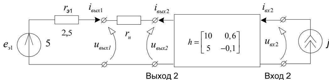
Рис. 12.2. Исходная схема после замены в ней системы 1 эквивалентной схемой Тевенена
