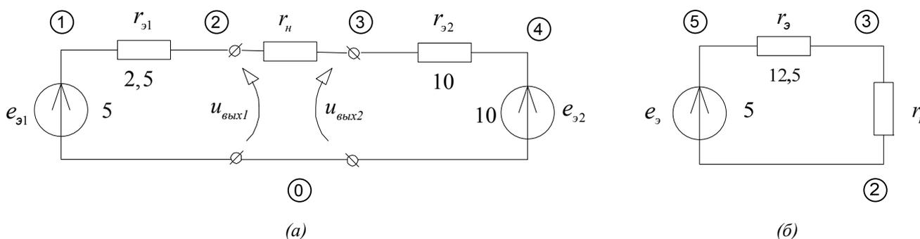
Рис. 12.3. (а) схема, образованная эквивалентными источниками напряжения и сопротивлением нагрузки; (б) упрощенная схема (а), эквивалентная исходной схеме с четырехполюсниками.
