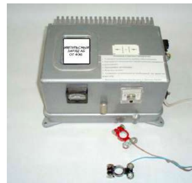
Імпульсний зарядний пристрій АБ від фотоелектричних установок
