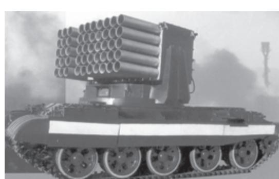
Багатоствольна установка імпульсного пожежагасіння
