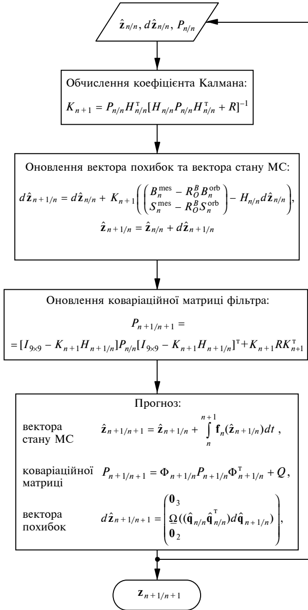
Рис. 2. Структурна схема алгоритму узагальненого фільтра Калмана оцінювання фазового вектора МС
