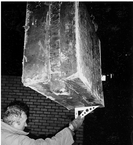
Рис. 3. Зовнішній вигляд моделі після заварювання порожнини
