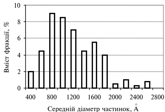
Рис. 4. Розподіл криохімічного \alpha - \text{Al}_2\text{O}_3 порошку за розмірами
